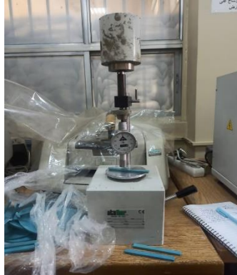
الشكل (4): جهاز الصلادة Shore D والعينة المختبرة
