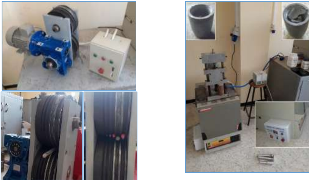
الشكل (5) آلة السباكة بالمزج المصنعة محلياً
